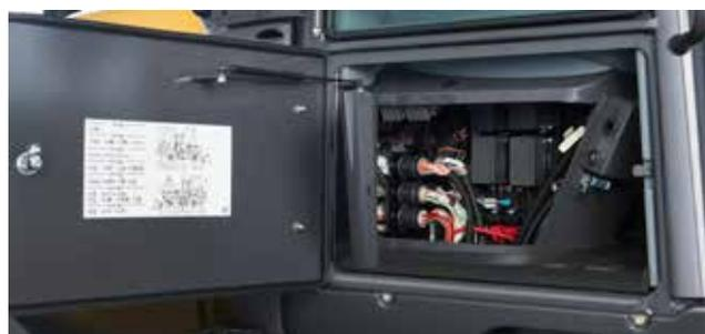
As portas laterais com abertura tipo “asa de gaivota” permitem total visibilidade e acessibilidade aos componentes internos. Todos os pontos de inspeção diária são alcançados com o operador no nível do solo.
