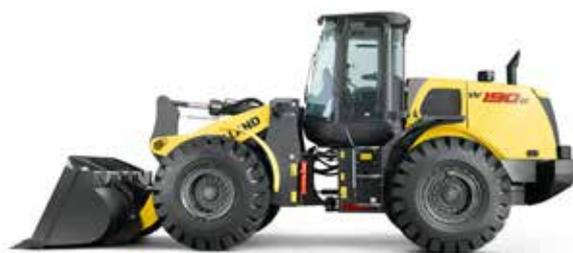
Os eixos com diferencial de patinagem limitada (*standard*) proporcionam excelente tração em qualquer tipo de terreno. A grande distância entre eixos e o reduzido raio de giro permitem manobras extremamente suaves.
