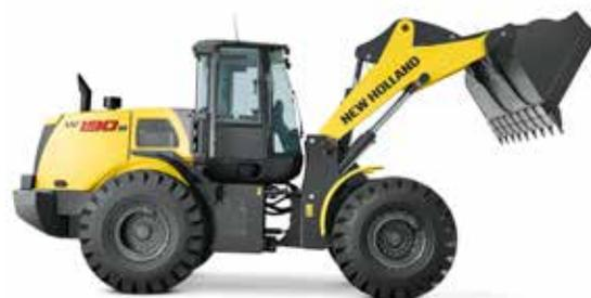
O braço Z-Bar proporciona uma excelente força de desagregação.
