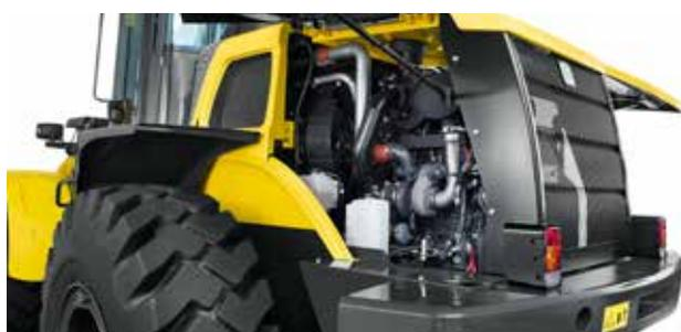
Motor com 3 curvas de potência, Tier IIIA, fornece elevado torque para os diferentes tipos de trabalho, utilizando todo o potencial energético do combustível, o que resulta em baixo custo operacional.
